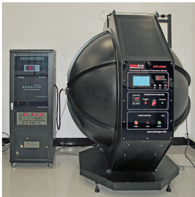
Вверху. Сфера для измерения светимости и прочих электрических и оптических параметров ламп.
