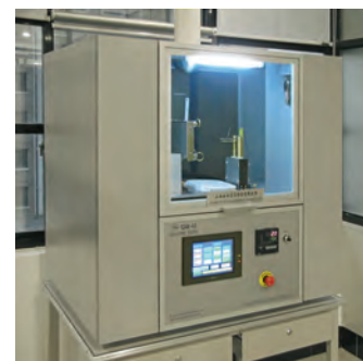
Внизу. Камера для проверки пластика на горючесть.
